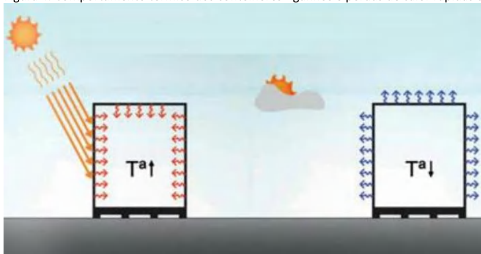
Figura 4: Comportamento térmico dos contêineres - ganhos e perdas de calor rápidas com o exterior.
